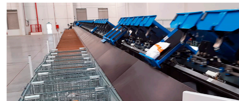
El LR-sorter se basa en la probadamente eficaz tecnología de clasificador de bandejas deslizantes (Slide Tray Sorter)
