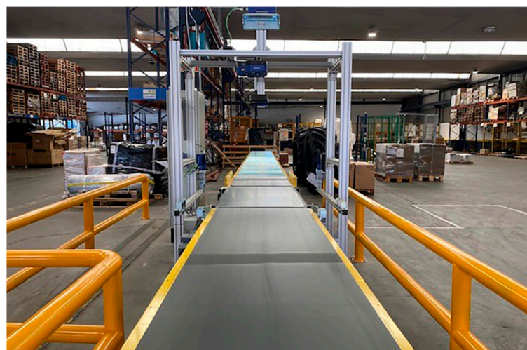
Sistema de captura de datos en las instalaciones de Auto-Radio
