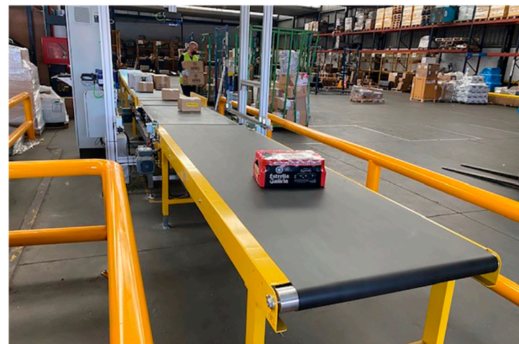
El sistema permite combinar funciones de pesado y cubicación de paquetes, lectura de CB y fotografías de los artículos.
