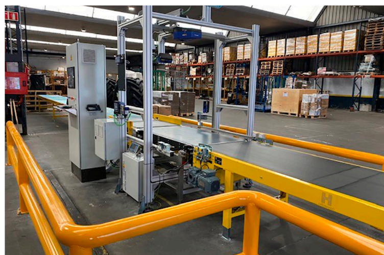
El analizador cuenta con báscula, pórtico de lectura, pesaje, volumétrico y captura de foto.
